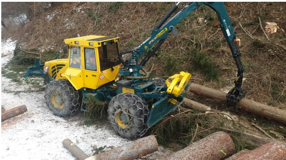
Abbildung 10: Rückeschlepper Occasion-Maschine
