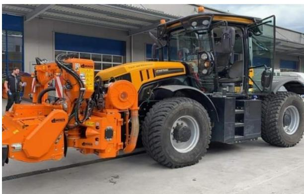
Abbildung 3: JCB-Geräteträger mit Mulchgerät
